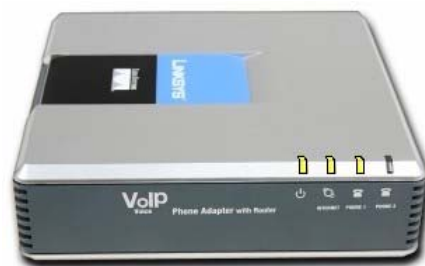
Рисунок 9. – Индикация правильно настроенного шлюза
