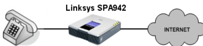
Рисунок 1. – Общая схема подключения шлюза
